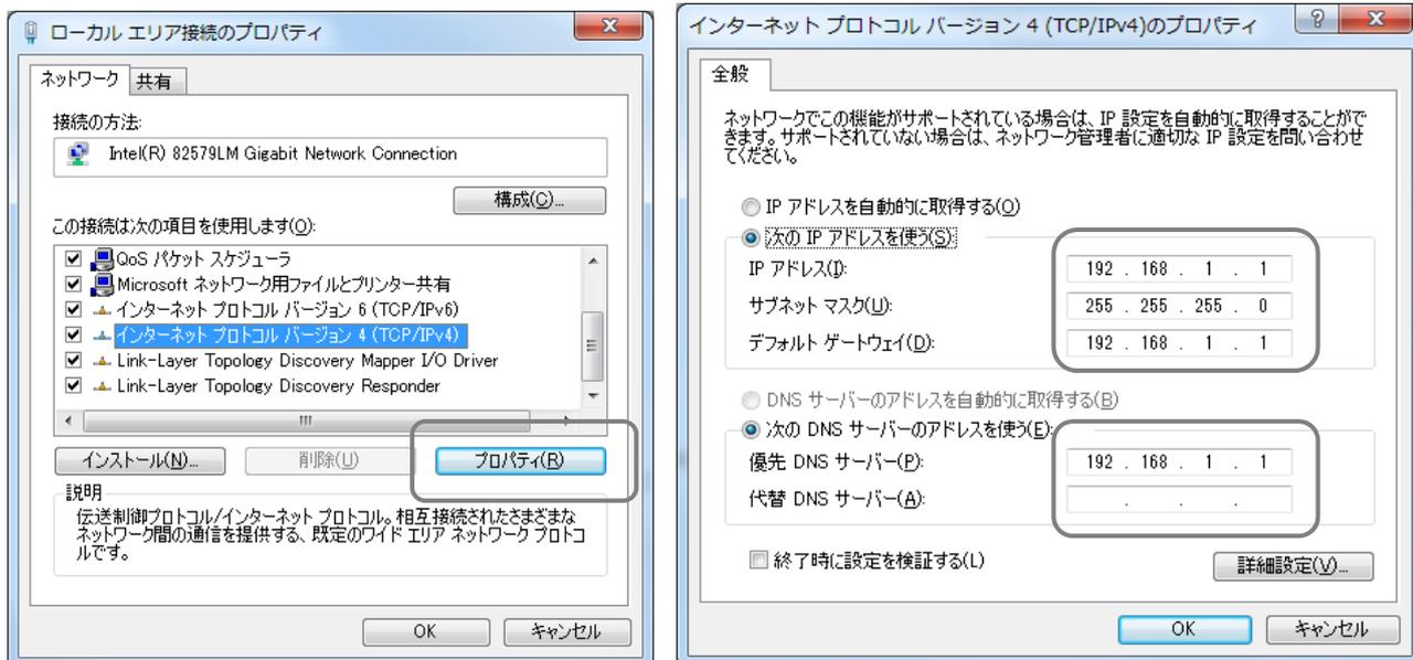
設定後、RJ45 Ethernet (LAN) ケーブルを PC と MB2 間に接続します。
